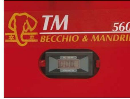
Kit contaore montato direttamente a lettura dello albero rotore.
