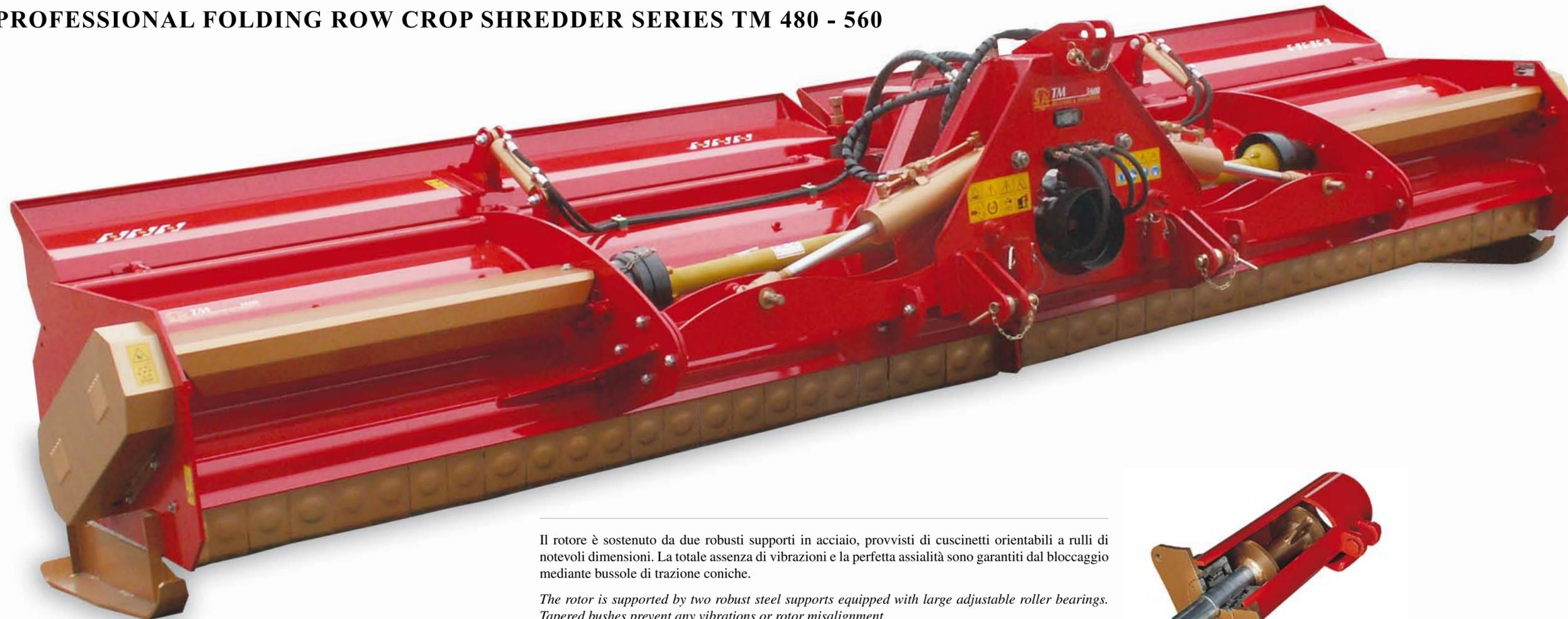
Il rotore è sostenuto da due robusti supporti in acciaio, provvisti di cuscinetti orientabili a rulli di notevoli dimensioni. La totale assenza di vibrazioni e la perfetta assialità sono garantiti dal bloccaggio mediante bussole di trazione coniche.
