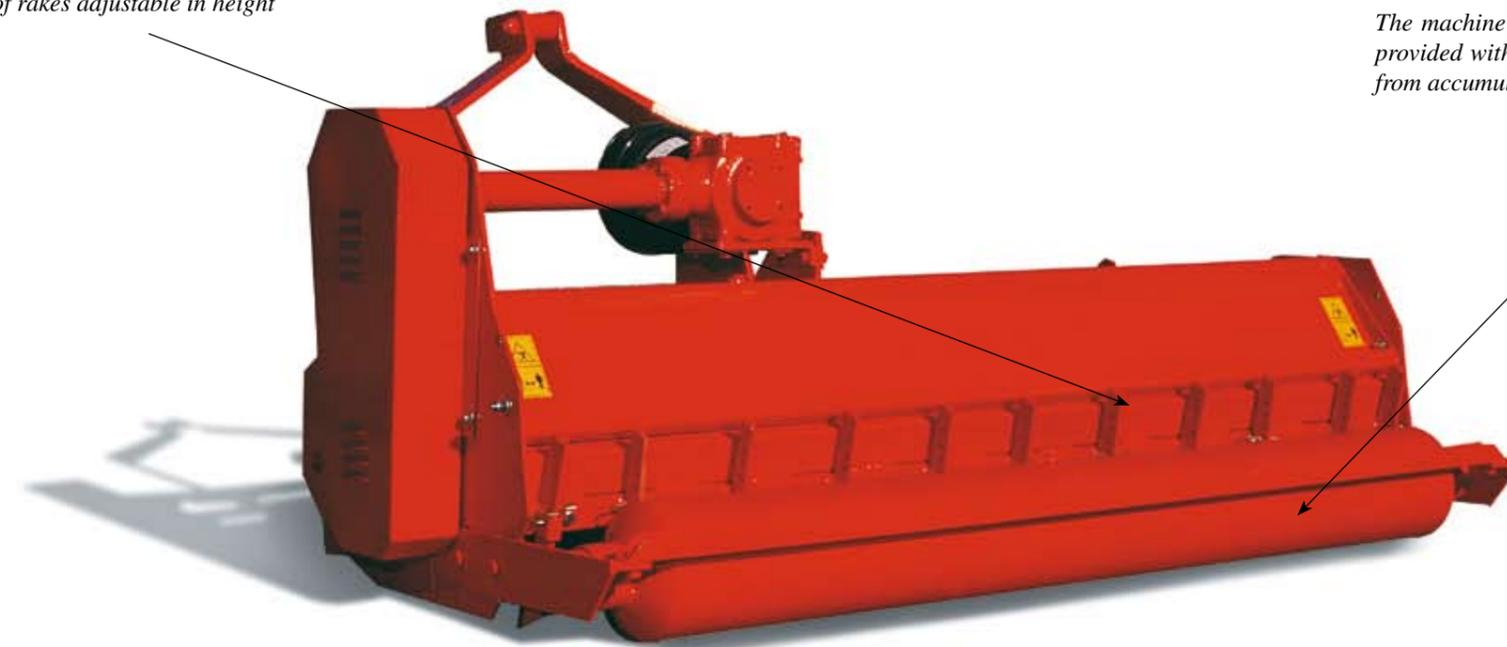
La stabilità della macchina è ottimizzata da un rullo di dimensioni maggiorate (diam =220 mm) sostenuto da supporti a cuffia provvisti di cuscinetto volante; il diametro elevato del rullo facilita il rotolamento evitando la formazione di mucchi ed il deposito di materiale trinciato sulla sua superficie.
