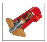
Il rotore è sostenuto da due robusti supporti in acciaio, provvisti di cuscinetti orientabili a rulli di notevoli dimensioni. La totale assenza di vibrazioni e la perfetta assialità sono garantiti dal bloccaggio mediante bussole di trazioni coniche.
